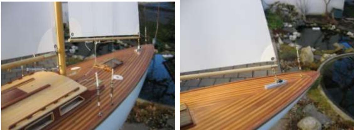
Wie Sie aus dem Foto ersehen können, habe ich eine kleine Luke auf das Vorschiff gesetzt. und eine U-Schiene aus dem Modellbau Zubehör zur Einstellung des Vorsegels. Auch die Wantenspanner (3,5mm Gewinde) sind aus dem Modellzubehör.
