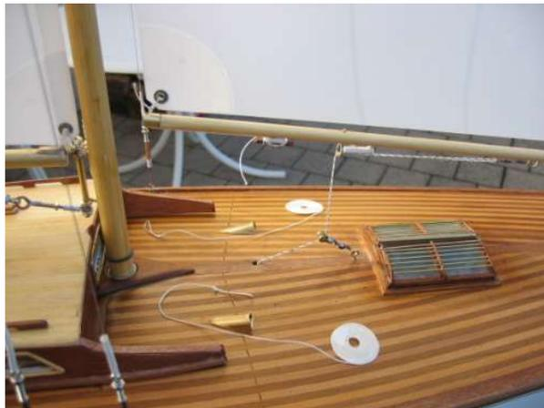
Die Schiebelucke habe ich aufschiebbar gemacht und darin den el. Schalter zum Einschalten der el. Anlage eingebaut.
