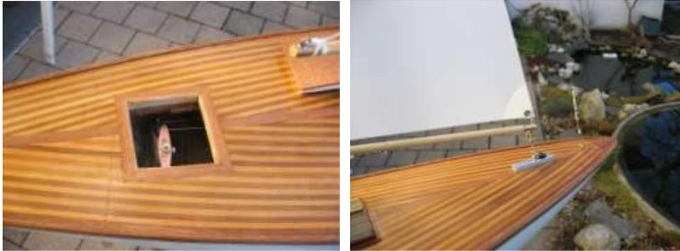
Der nächste Arbeitsschritt ist das Vorbereiten zur ersten Belegung mit dünnem Flugzeug Sperrholz für die spätere Deckbelegung mit Red Zeder Leisten hell und dunkel und einer Mahagoni Königsleiste. Die Deckleisten habe ich mit Ponal blau (wasserfest) auf dem Sperrholzdeck verlegt und anschließend mehrmals geschliffen. Nach dem der Rumpf fertig war, habe ich das Deck mit einem Klarlack matt 2-3 mal lackiert.
